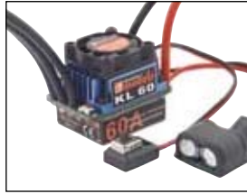
1101 Fahrregler KL-60 ESC KL-60
