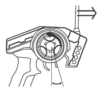
Drehen Sie am Lenkrad nach links das Modell fährt nach links, drehen Sie am Lenkrad nach rechts fährt das Modell nach rechts. Beachten Sie das die Steuerung anders reagiert wenn Sie auf sich zu fahren.
