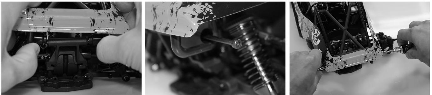
Aus verpackungstechnischen Gründen ist es nötig, dass das Modell mit nicht montierten Karosserie geliefert wird. Bitte schrauben Sie die Karosserie wie im Bild zu sehen an die Karosserihalterung des Modells.
