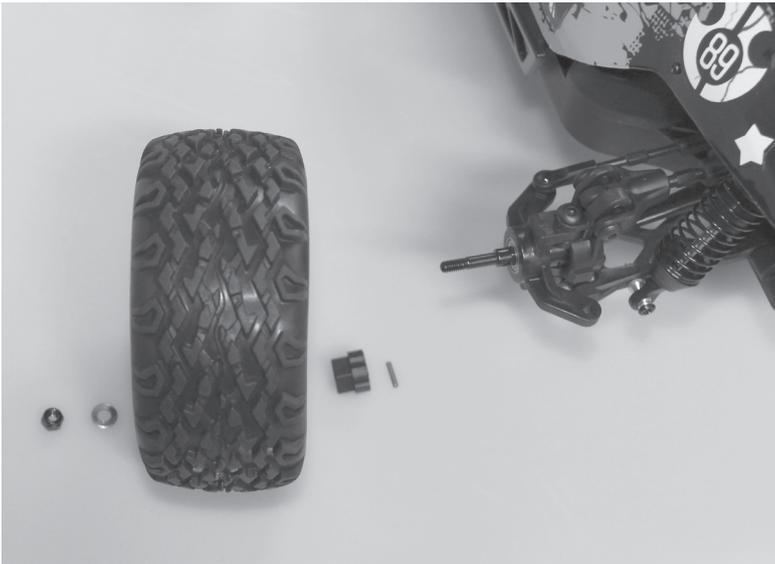
Bei der Montage der Räder die Radmuttern zuerst fest anziehen und die Leichtläufigkeit der Räder kontrollieren. Anschließend so lange die Radmuttern wieder lockern bis sich die Räder leichtgängig drehen lassen.
